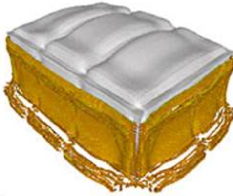
结构在内部爆炸冲击后的变形
